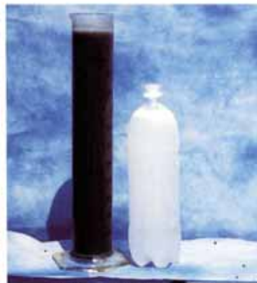
処理前 (汚泥と凝集剤)
