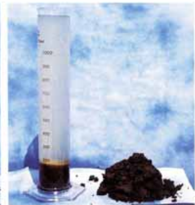
処理後 (処理水と汚泥)
