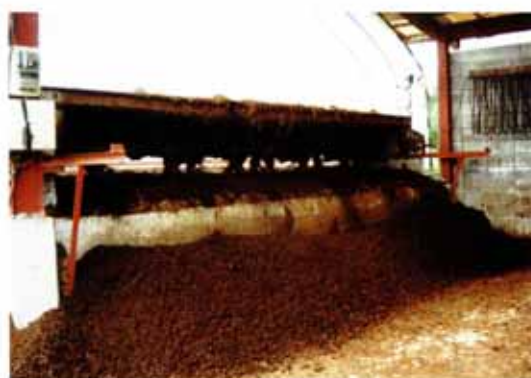
水分が調整されて出てきた状態（これを堆積発酵させる）
